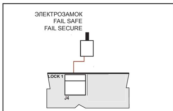
В комплект электрозамка входит кабель питания, который с одного конца заканчивается двумя проводниками для соединения с соответствующими клеммами выходных контактов соленоида электрозамка, а с другой стороны — контактом, который следует вставить в разъем LOCK1 электронного блока управления привода ETERNA 90 EASY.
