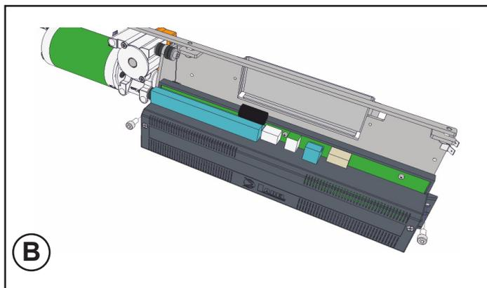
Снимите контейнер электронного блока управления, отвинтив два винта M5x10.
