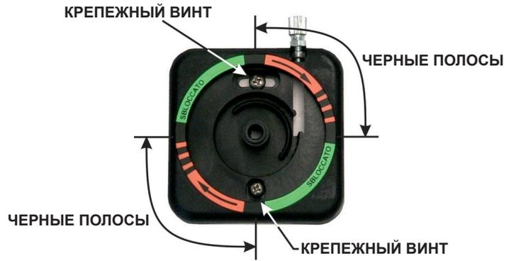
Просверлите стену и закрепите нижнюю часть механизма разблокировки с помощью крепежных винтов. Поместите этикетку, как показано на рисунке, ориентируясь на четыре черные полосы на этикетке, которые следует расположить в 4 главных точках. Вставьте регулировочную задвижку с двумя гайками: одну вставьте в специальную пластиковую прорезь, а другую — снаружи.
