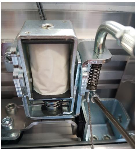
Установите пружину сжатия и вставьте металлический трос внутрь соответствующего фиксатора, затем зафиксируйте его с помощью винтового зажима. Отрегулируйте натяжение троса, чтобы обеспечить небольшую предварительную нагрузку пружины.
