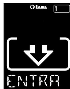
**АВТОМАТИЧЕСКИЙ:** Дверь открывается и закрывается автоматически в обоих направлениях со всеми активными датчиками.
