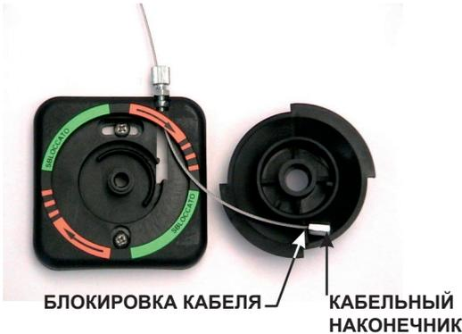
Пропустите трос механизма разблокировки через отверстие в нижней части, а затем в регулировочную задвижку, как показано на рисунке, после чего поместите наконечник троса на фиксатор троса ручки разблокировки (см. Рис.).
