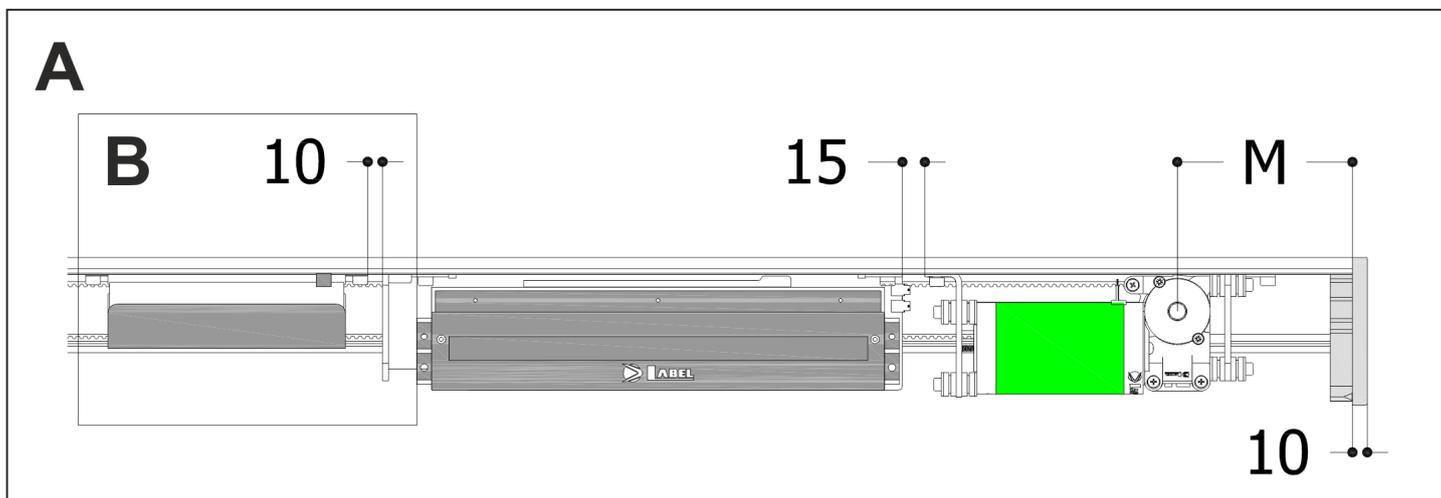
В случае, если в комплекте имеется аккумулятор **ET-BAT90**, для его установки в поперечном направлении относительно блока управления должен использоваться код ET-KBAT420, см. чертеж **B**.
