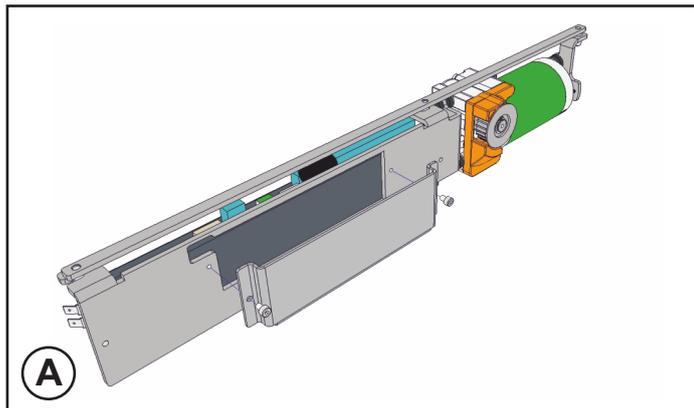
Удерживающая панель аккумулятора закреплена на задней части модуля ET-DRIVE/90 с помощью винтов TCEI 4x6.
