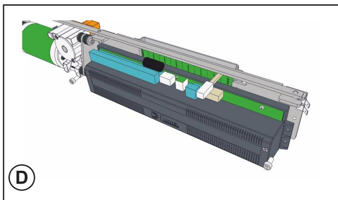
Установите контейнер электронного блока управления, пропустив кабель батареи через паз в верхней части и затянув винты M5x10.
