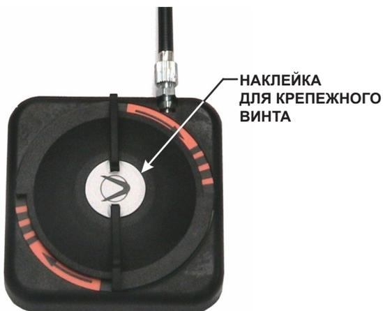
После вставки ручки затяните крепежный винт, вставьте оболочку и переведите ручку в положение НЕ РАЗБЛОКИРОВАНА. В этом положении должна быть видна только оранжевая часть этикетки с обозначенными черными стрелками.
