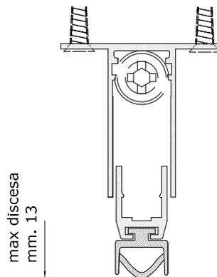
**Функции:** автоматическое закрытие щели между дверью и полом для защиты от сквозняков, проникновения пыли, насекомых, дыма, а также с целью звукоизоляции.
