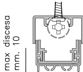
**Функции:** автоматическое закрытие щели между дверью и полом для защиты от сквозняков, проникновения пыли, насекомых, дыма, а также с целью звукоизоляции.
